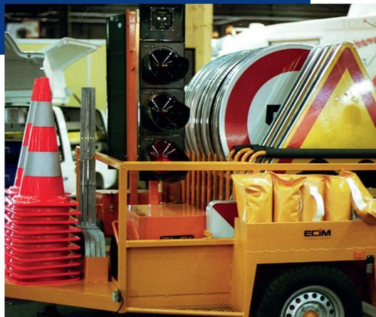
Pour les chantiers de quelques heures (rescellement d'une plaque d'égout, abaissement d'une bordure de trottoir, etc.), les panneaux AK5, K8 et les cônes suffisent.
